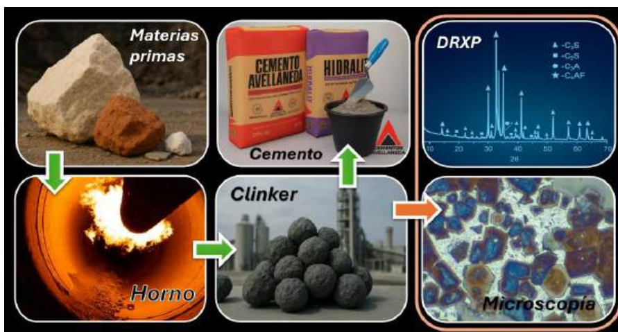
Figura 1. Esquema del proceso de producción y caracterización del cemento Portland.
