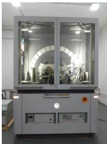
Figura 1. Difractómetro Empyrean multicore para radiación de Cu y detector Pixel3D del LINARX
